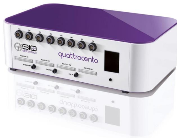
Picture 8. Quattrocento amplifier (OT Bioelettronica, Torino, Italy, 3 dB, bandwidth 10–500 Hz)
